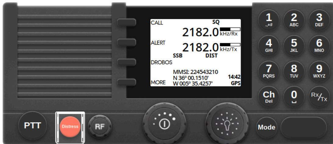
La radio MF/HF con Digital Selective Calling (DSC) es estructural y funcionalmente similar a la radio VHF, pero está diseñada para comunicaciones de media y alta frecuencia a largas distancias. Las principales diferencias y funcionalidades adicionales se describen a continuación.
