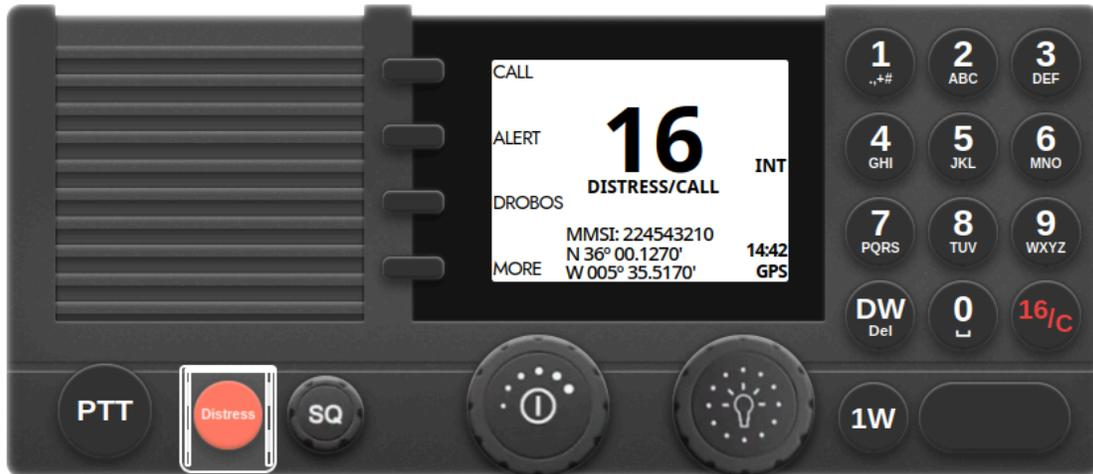
La Radio VHF con Digital Selective Calling (DSC) es un dispositivo de comunicación equipado con una pantalla, múltiples botones y mandos. Ofrece funciones esenciales de comunicación marítima, incluyendo llamadas de distress, selección de canal y escaneo.
