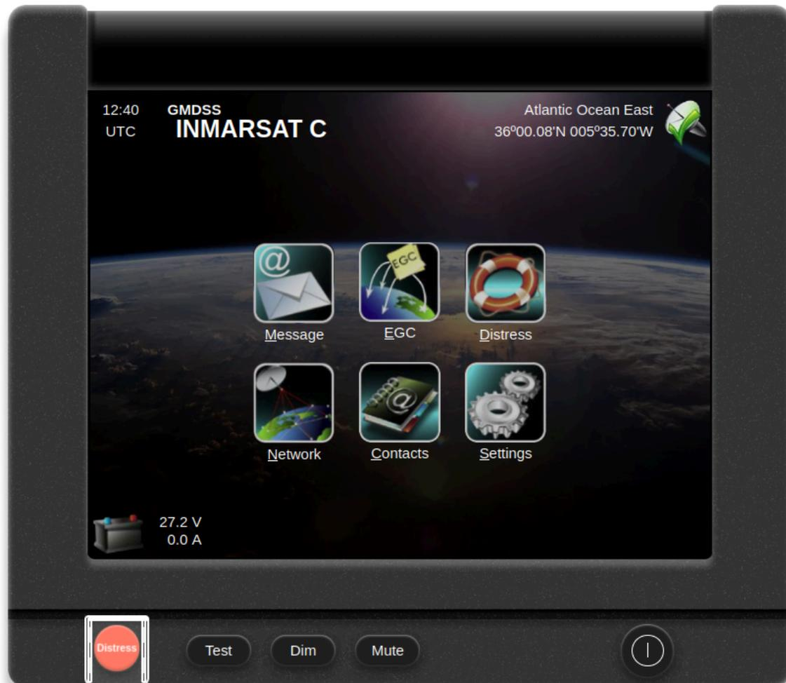
El Inmarsat-C Terminal es un dispositivo de comunicación con una interfaz tipo pantalla táctil que permite a los usuarios interactuar mediante clics del ratón. Cuenta con cinco botones físicos en la parte inferior de la consola:
