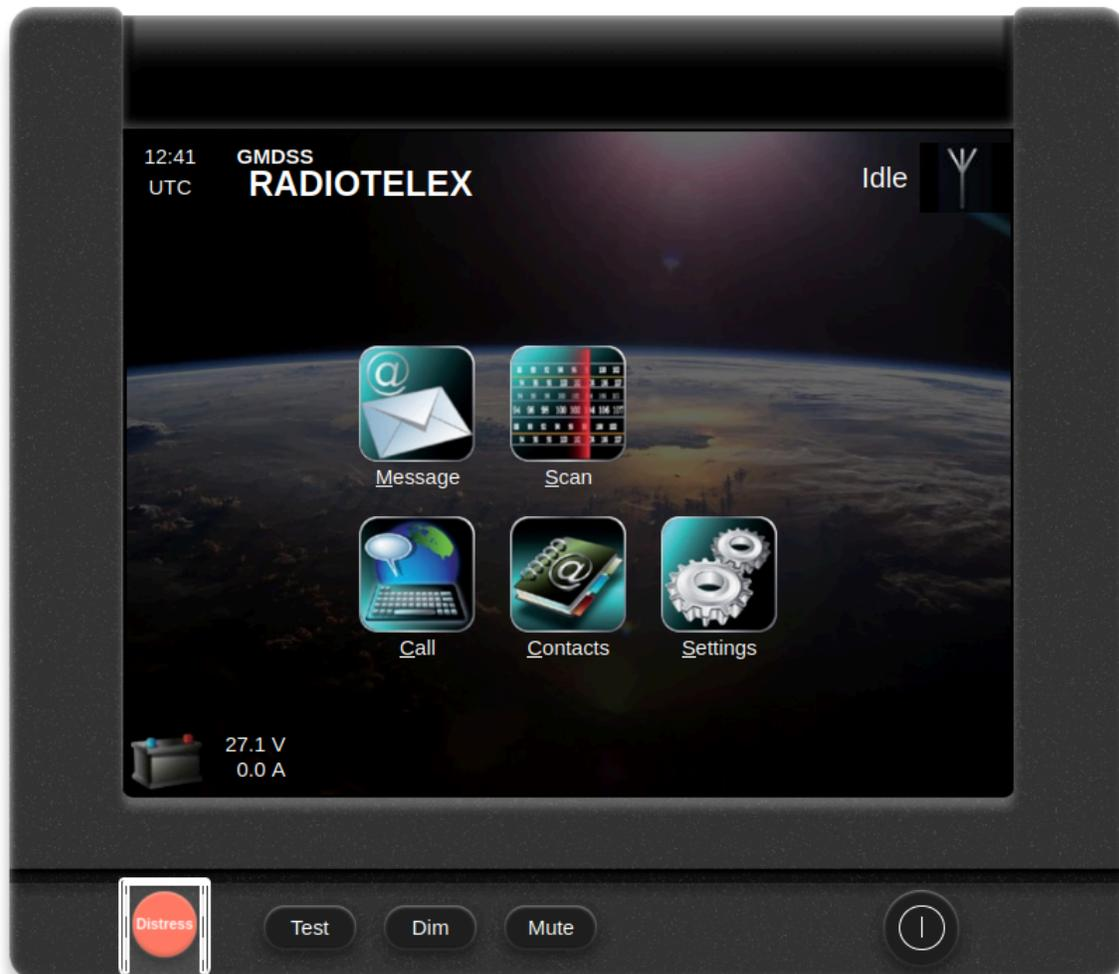
El Terminal RadioTelex es un dispositivo de comunicación diseñado para mensajería marítima basada en texto. Cuenta con una interfaz tipo pantalla táctil para interactuar mediante clics del ratón e incluye cinco botones físicos en la parte inferior:
